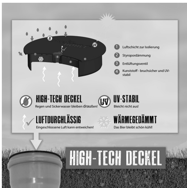
Abbildung 3.1: HopfenHöhle LIFT Deckel mit Entlüftungsventil
