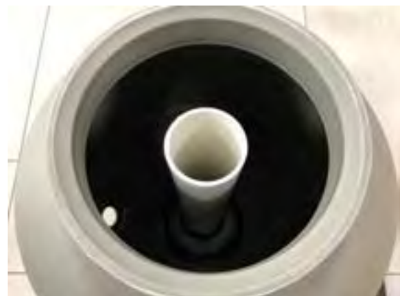
Abb. Innenverrohrung stehend (mittig) im Filterkessel
