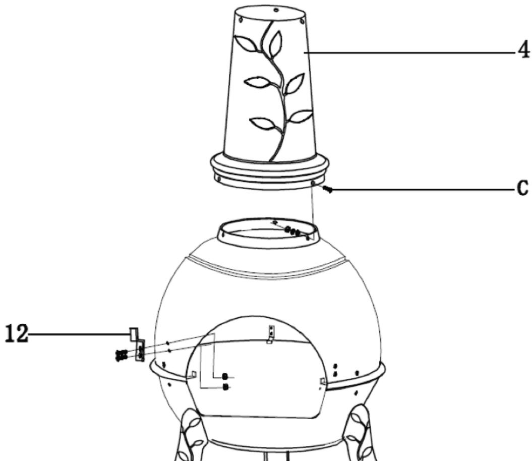
**SCHRITT 3** - Befestigen Sie den unteren Abzug (4) an der oberen Feuerschale (5) mit 3 x Schraubensatz (C). Bringen Sie die Türverriegelung (12) auf die linke Seite der oberen Feuerschale (5) mit den vormontierten Schrauben und Muttern an.
