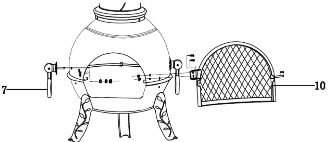
**SCHRITT 5** – Bringen Sie die Griffe (7) an der oberen Feuerschale (5) mit den vormontierter Schrauben und Muttern an. Befestigen Sie die Schutztür (10) auf der rechten Seite der oberen Feuerschale (5) mit den vormontierten Schrauben und Muttern.
