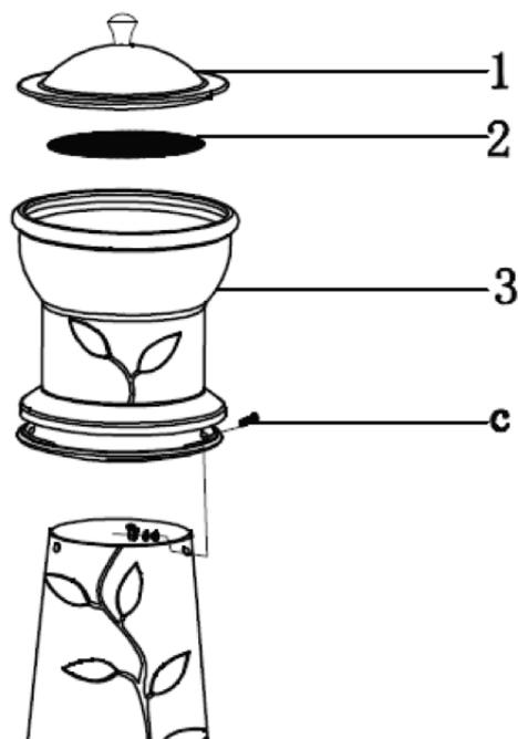
**SCHRITT 4** – Befestigen Sie den oberen Abzug (3) an den unteren Abzug (4) unter Verwendung von Schraubensatz (C). Platzieren Sie das Gitter für den Abzug (2) auf die Oberseite des Abzugs (3) und platzieren Sie den Regendeckel (1) auf die Oberseite des Abzugs (3). Stellen Sie sicher, dass der Deckel vor Gebrauch entfernt wird.
