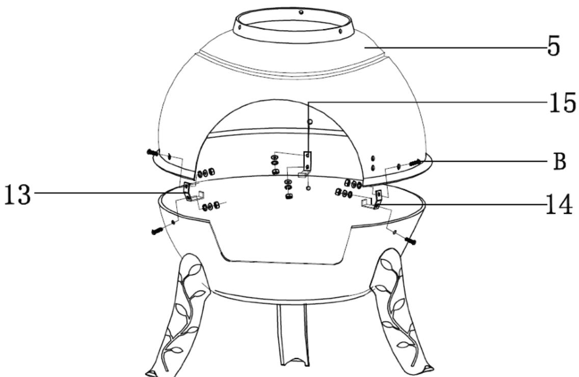
**SCHRITT 2** - Stellen Sie die Feuerstelle aufrecht hin. Befestigen Sie die Beschläge 13, 14 und 15 an der unteren Feuerschale (6) mit 1 x Schraubensatz (B) und ziehen Sie diese von Hand fest. Platzieren Sie die obere Feuerschale (5) auf der unteren Feuerschale (8) und richten Sie die Löcher der Schale mit den Beschlägen aus. Fixieren Sie die obere Feuerschale mit 1 x Schraubensatz (B) an den Beschlägen 4, 5 und 6 und ziehen Sie diese von Hand fest.
