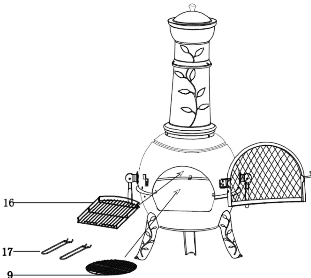
**SCHRITT 6** - Platzieren Sie den Feuerrost (9) in der unteren Feuerschale der Feuerstelle. Befestigen die Griffe des Grillrostes (17) an den Grillrost (16). Der Grillrost kann nun in die Feuerstelle geschoben werden und auf den Beschlägen aufliegen.
