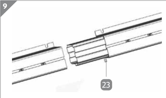
5. Setzen Sie eine M6×12-mm-Schraube **23** wie dargestellt in den Ihnen zugewandten Schraubenkanal des von Ihnen aus gesehen rechten Längsträgers.
