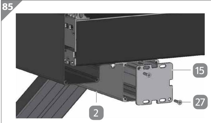
1. Setzen Sie eine der Längsträger-Abdeckkappen **15** auf ein Ende eines der Längsträger **2**.
