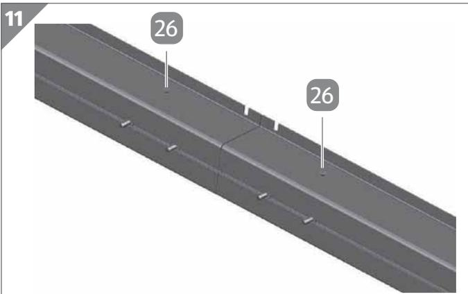
7. Verschrauben Sie die beiden Längsträger und das Längsträger-Verbindungsstück mit jeweils einer gewindeformenden 4,8×13-mm-Blechschrabe **26** pro Längsträger, damit sie nicht mehr auseinander gezogen werden können.
