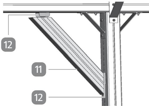
19. Befestigen Sie ein Kopfband **11**, indem Sie es in die Kopfbandaufnahme **12** am Pfosten sowie in die Kopfbandaufnahme an der Unterseite des Längsträgers einhängen.
