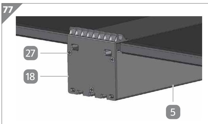
6. Setzen Sie die zweite Koppelträger-Abdeckkappe **18** auf das Ende des Koppelträgers **5**, welches noch nicht mit einer Koppelträger-Abdeckkappe versehen ist.
