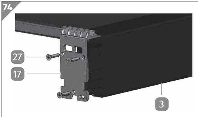
1. Setzen Sie eine Querträger-Abdeckkappe **17** auf das Ende eines der Außenquerträger **3**, welches noch nicht mit einer Querträger-Abdeckkappe versehen ist.
