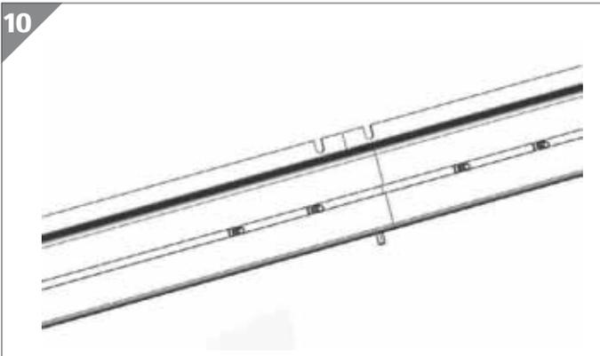
6. Schieben Sie beide Längsträger soweit zusammen, dass sie bündig aneinander liegen.
