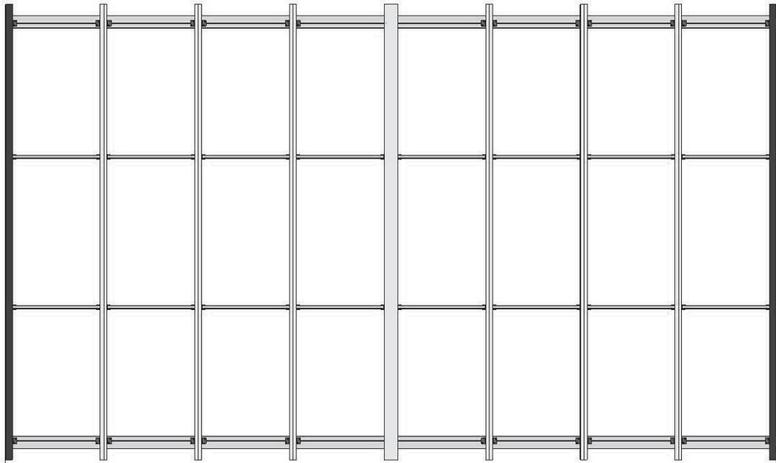
Im diesem Abschnitt werden die Unterzüge angebracht, welche quer zu den später zu montierenden Doppelsteigplatten der Dachfläche verlaufen. Die Unterzüge sollen verhindern, dass sich die Doppelsteigplatten unter dem Gewicht größerer Schneemengen durchbiegen.
