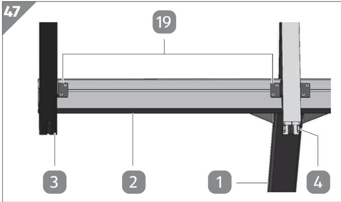
In diesem Abschnitt werden die Außen- und Innenquerträger über Sturmhaken zusätzlich gesichert. Dabei werden die Außenquerträger **3** von einer Seite aus durch Sturmhaken **19** gesichert, während die Innenquerträger **4** auf zwei Seiten mit Sturmhaken versehen werden.
