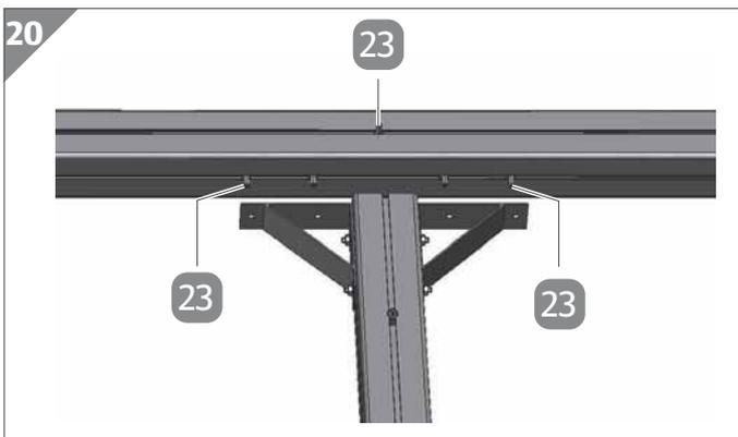
9. Positionieren Sie die zuvor in einen der Längsträger eingesetzte M6×12-mm-Schraube **23** genau mittig am Stoß.
