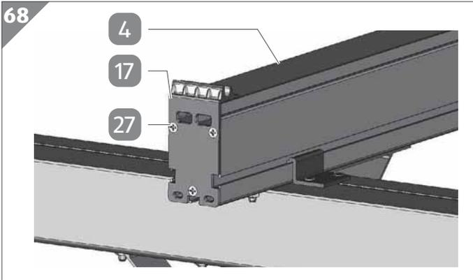
4. Setzen Sie jeweils eine Querträger-Abdeckkappe **17** auf ein Ende jedes Innenquerträgers **4**. Achten Sie darauf, dass Sie alle Abdeckkappen auf derselben Seite des Produkts montieren.
