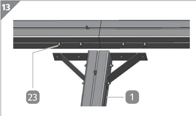
Zuerst wird der mittlere Pfosten mit den Längsträgern verschraubt.
