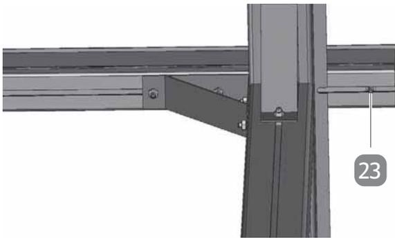
11. Setzen Sie an beiden Enden des Innenquerträgers eine M6×12-mm-Schraube **23** in den Schraubenkanal des Innenquerträgers ein. Folgen Sie dabei der Darstellung.
