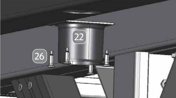
1. Nehmen Sie einen der Ablaufstutzen **22** sowie vier gewindeformende 4,8×13-mm-Blechschraben **26**.
