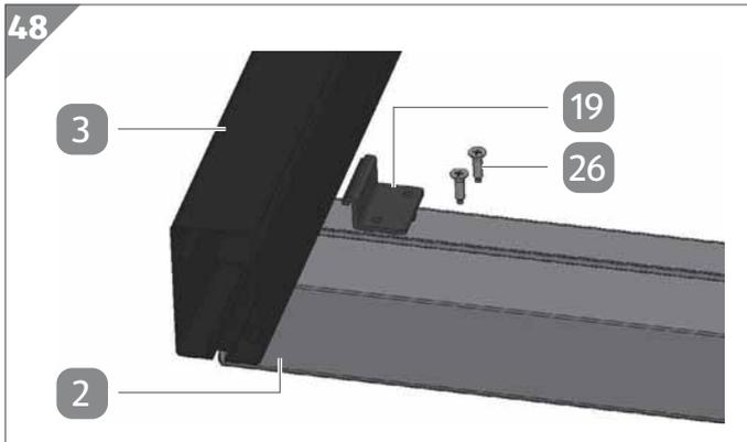
1. Setzen Sie im Bereich eines der Außenquerträger **3** einen Sturmhaken **19** in den oberen Schraubkanal eines der Längsträger **2** ein.
