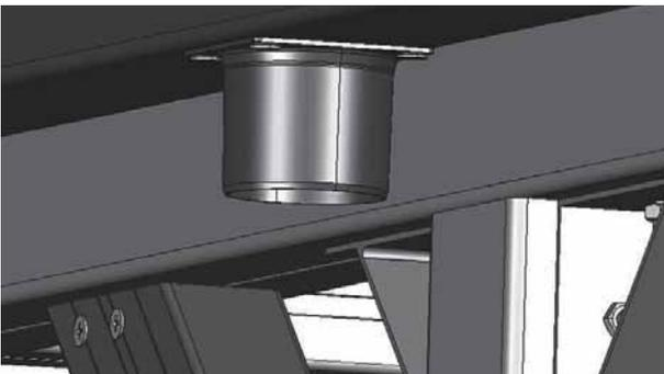
3. Verschrauben Sie den Ablaufstutzen mit der Regenrinne. Verwenden Sie dafür die gewindeformenden 4,8×13-mm-Blechschraben.
