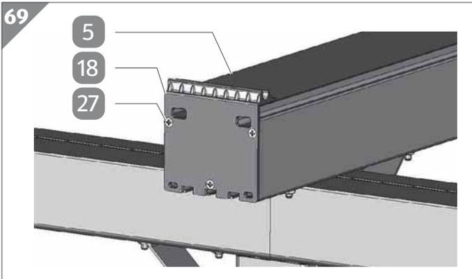
6. Setzen Sie eine Koppelträger-Abdeckkappe **18** auf ein Ende des Koppelträgers.
