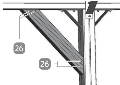
21. Verschrauben Sie das Kopfband wie dargestellt mit den Kopfbandaufnahmen. Verwenden Sie dazu pro Kopfbandende auf jeder Seite zwei gewindeformende 4,8×13-mm-Blechschauben **26**.
