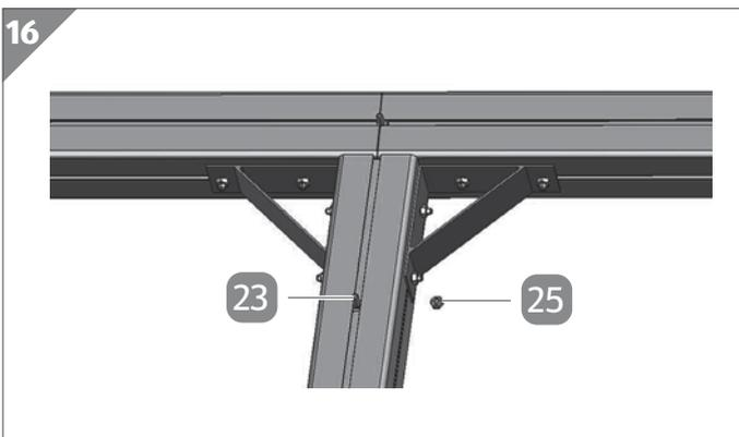
8. Lösen Sie die M6-Mutter **25** mit der Sie zuvor die M6×12-mm-Schraube **23** an der Vorderseite des Pfostens fixiert haben.
