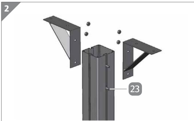
2. Setzen Sie je zwei M6×12-mm-Schrauben **23** in die Schraubenkanäle auf den entsprechenden Seiten des ersten Pfostens ein.
