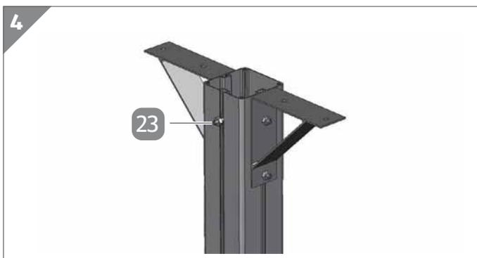
5. Setzen Sie eine M6×12-mm-Schraube **23** in den Schraubkanal wie dargestellt an der Vorderseite des Pfostens ein.
