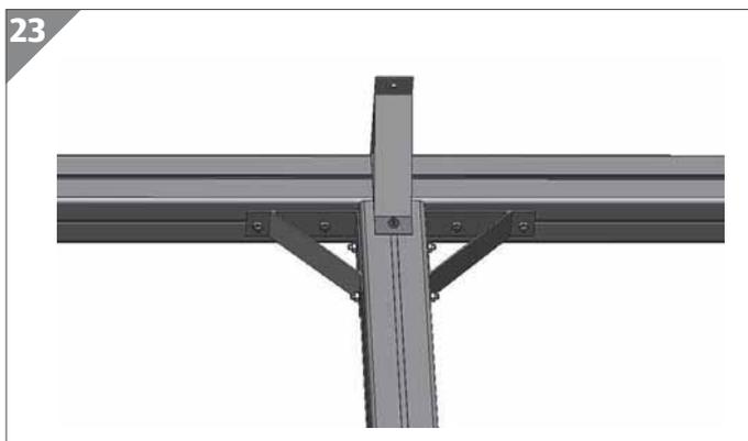
17. Positionieren Sie die vier M6×12-mm-Schrauben in den Ihnen zugewandten Schraubenkanäle so, dass sie auf einer Linie mit den Durchgangslöchern der Winkel liegen.
