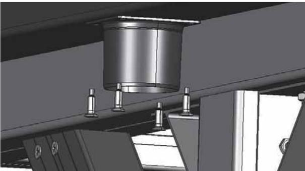
2. Setzen Sie den Ablaufstutzen an der dafür vorgesehenen Durchlassöffnung einer der Regenrinnen an. Achten Sie dabei darauf, dass der Durchlass des Ablaufstutzens exakt bündig mit der Durchlassöffnung der Regenrinne abschließt.
