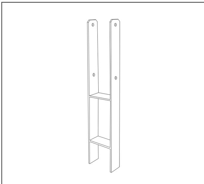
1. Heben Sie Löcher zum Einzementieren der Pfostenanker aus. Achten Sie dabei darauf, dass der Abstand zwischen den Löchern den Abständen zwischen den Pfosten des Produkts entspricht.
