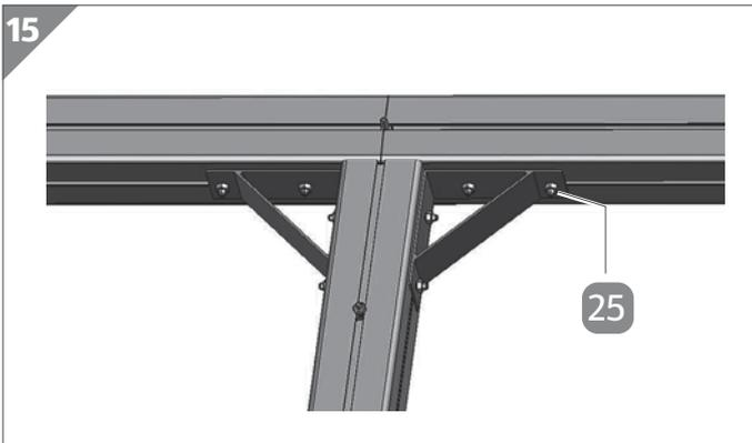
6. Richten Sie den Pfosten so aus, dass der Stoß der beiden Längsträger exakt auf einer Linie mit der Mitte des Schraubenkanals liegt.
