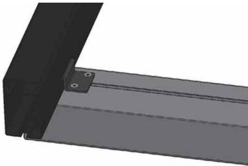
3. Verschrauben Sie den Sturmhaken mit dem Längsträger. Verwenden Sie hierfür zwei gewindeformende 4,8×13-mm-Blechschrauben **26**. Schrauben Sie die Schrauben mithilfe eines Akkuschraubers **30** ein.
