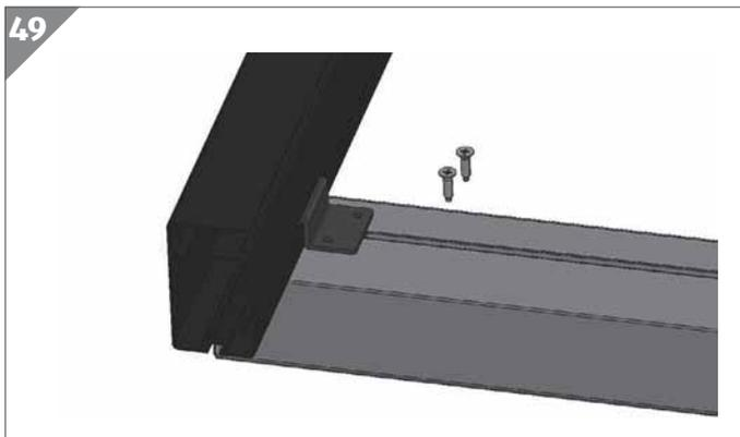
2. Schieben Sie den Sturmhaken bis zum Anschlag an den Außenquerträger. Achten Sie darauf, dass der Sturmhaken mit dem Außenquerträger abschließt.
