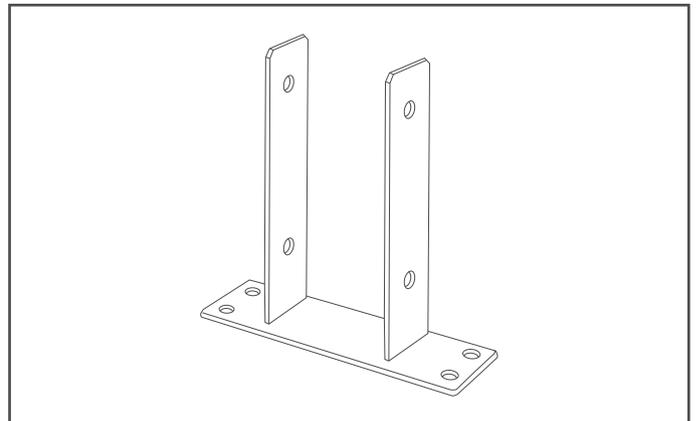
1. Verschrauben Sie die Pfostenanker mit den Pfosten des Produkts. Berücksichtigen Sie dabei, dass das Produkt auf einer Längsseite ca. 15 mm höher liegen sollte, damit ein leichtes Gefälle entsteht, wodurch das Regenwasser zu einer Seite ablaufen kann.
