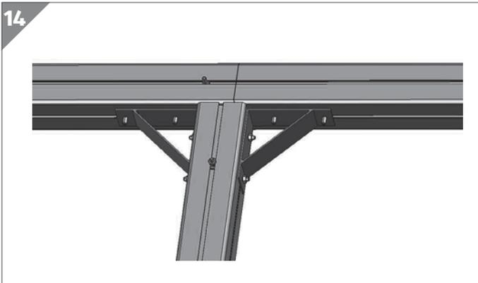
4. Richten Sie die M6×12-mm-Schrauben so aus, dass sie exakt auf einer Linie mit den Durchgangslöchern der Winkel liegen.
