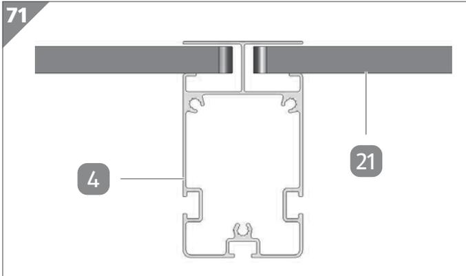
1. Setzen Sie die erste Doppelstegplatte **21** zwischen dem vorderen Außenquerträger **3** und dem dahinter liegenden Innenquerträger **4** ein. Schieben Sie die Doppelstegplatte dabei in die entsprechenden Nuten beider Querträger ein, wobei Sie die Doppelstegplatte bis zum Anschlag einschieben.
