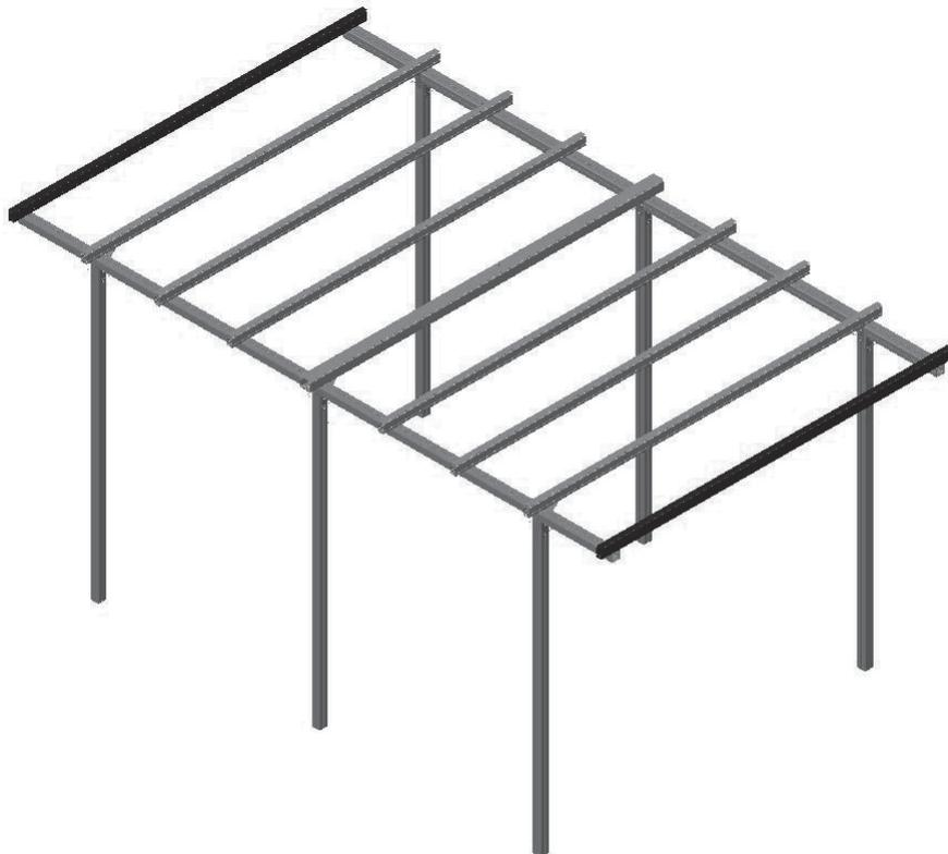
In diesem Abschnitt werden die verbleibenden vier Innenquerträger an den Stellen montiert, welche durch die Stanzungen in den Überständen der Längsträger vorgegeben sind.
