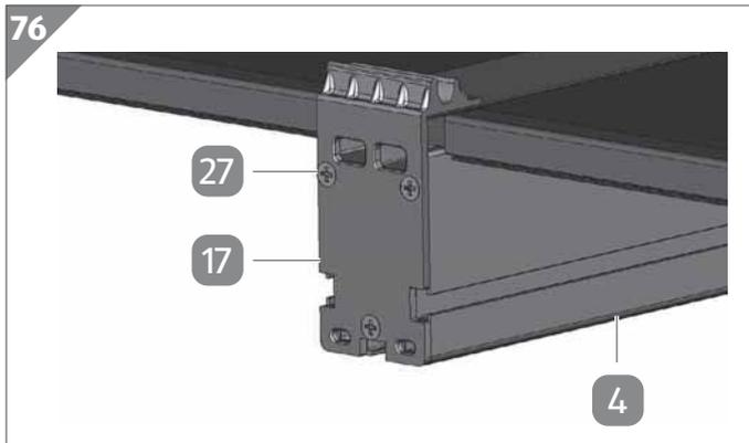
3. Setzen Sie eine Querträger-Abdeckkappe **17** auf das Ende eines der Innenquerträger **4**, welches noch nicht mit einer Querträger-Abdeckkappe versehen ist.
