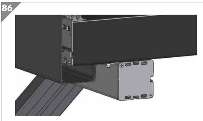
2. Verschrauben Sie die Längsträger-Abdeckung mit dem Längsträger. Verwenden Sie dafür zwei 4,2×22-mm-Blechschraben **27**.
