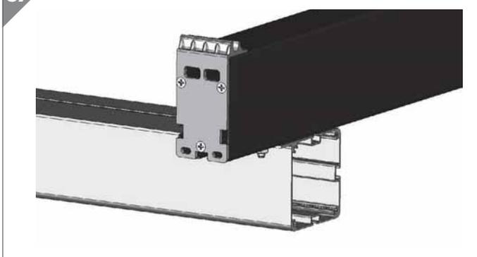
2. Verschrauben Sie die Querträger-Abdeckkappe und den Außenquerträger mithilfe von drei 4,2×22-mm-Blechschauben **27**. Verwenden Sie hierfür einen Kreuzschlitzschraubendreher **28**.
