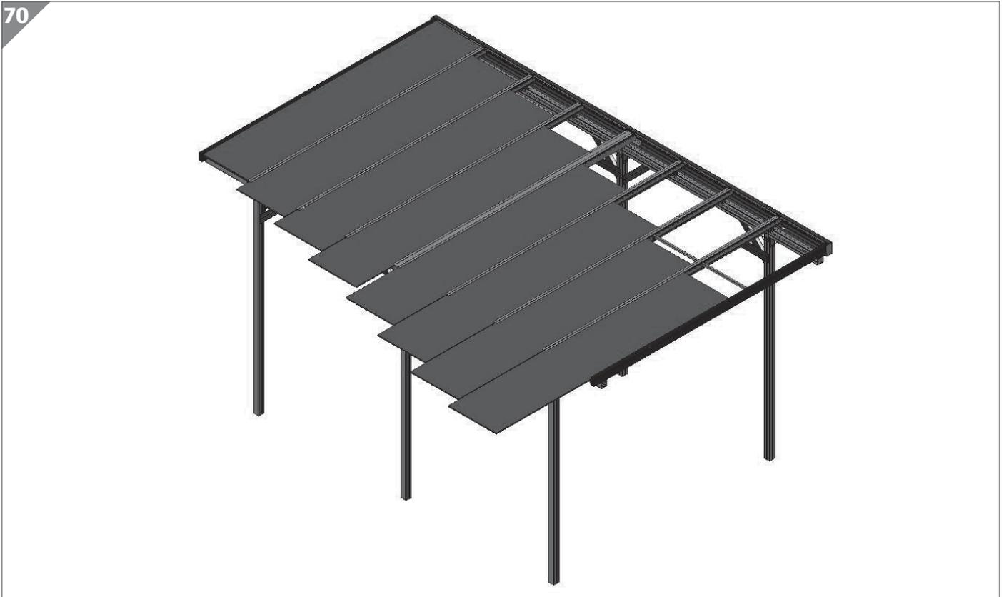
In diesem Schritt werden die Doppelstegplatten in die entsprechenden Nuten der Außen- und Innenquerträger sowie des Koppelträgers eingesetzt. Die Doppelstegplatten bilden später das Dach des Produkts.
