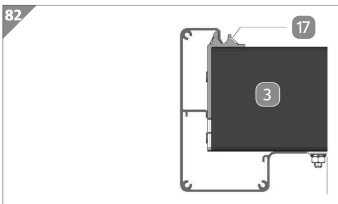
1. Hängen Sie die Regenrinnen wie dargestellt in die Querträger-Abdeckkappen **17** und in die Koppelträger-Abdeckkappen **18** ein. Achten Sie hierbei darauf, dass Sie die Regenrinne mit den Öffnungen zum Einsetzen der Ablaufstutzen auf der Seite des Produkts einhängen, welche später die etwas niedriger gelegene Seite sein wird. Stellen Sie außerdem sicher, dass die Regenrinnen in jede Abdeckkappe korrekt eingehängt und richtig positioniert sind.
