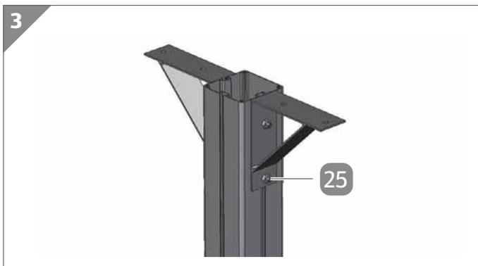
3. Setzen Sie die Winkel auf die M6×12-mm-Schrauben. Stellen Sie dabei sicher, dass die Winkel an der Oberseite bündig mit den Pfosten abschließen.
