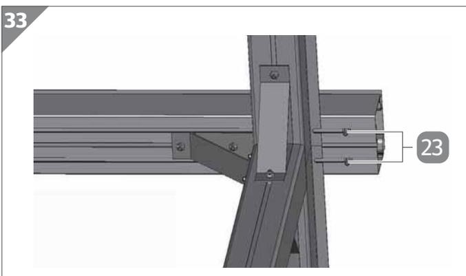
5. Richten Sie den Koppelträger so aus, dass er auf beiden Seiten exakt 80 mm über die Überstände der Längsträger hinausragt.
