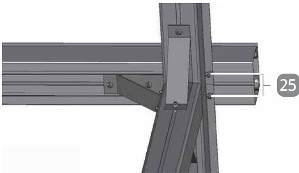
11. Schieben Sie die M6×12-Schrauben bis zum Anschlag in die Stanzungen in den Überständen der Längsträger.
