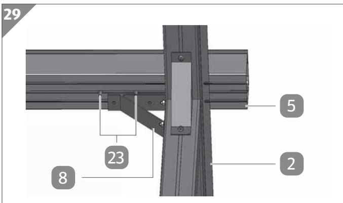
1. Setzen Sie an beiden Enden des Koppelträgers **5** je zwei M6×12-mm-Schrauben **23** in den mittleren Schraubenkanal ein.
