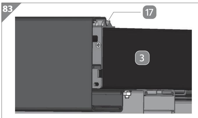
3. Drücken Sie die erste der beiden Regenrinnen nach innen und verschrauben Sie sie mit dem ersten Außenquerträger. Verwenden Sie hierfür eine gewindeformende 4,8×13-mm-Blechschaube **26**.
