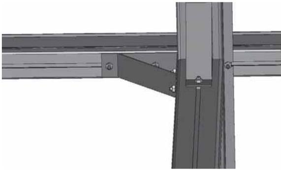
13. Verschrauben Sie den Innenquerträger und die Längsträger. Verwenden Sie hierfür pro M6×12-mm-Schraube eine M6-Mutter **25**.
