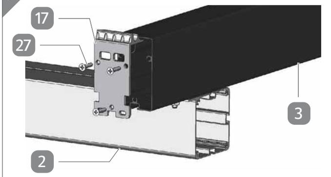
1. Setzen Sie eine Querträger-Abdeckkappe **17** auf ein Ende eines Außenquerträgers **3**.
