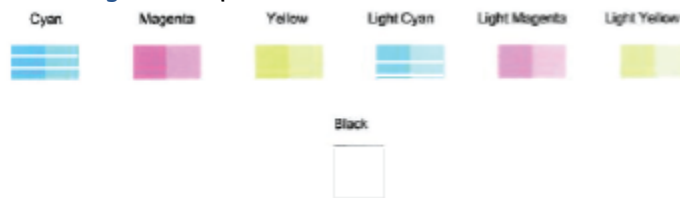
Abbildung 9-2 Beispiele für fehlerhafte Farbböcke
