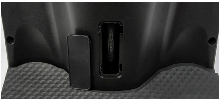
\*Die Fahrgestellnummer befindet sich an der vorderen Konsole mittig unten, über der Trittfläche, hinter der Abdeckung.
