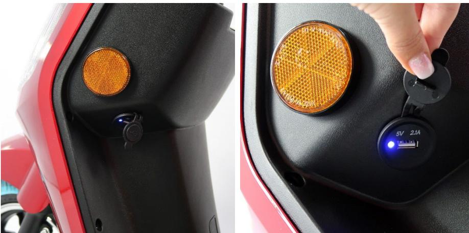
Die USB-Ladebuchse befindet sich an der vorderen Konsole links, unter dem orangenen Reflektor und ist kompatibel mit jedem gängigen USB-Kabel.
