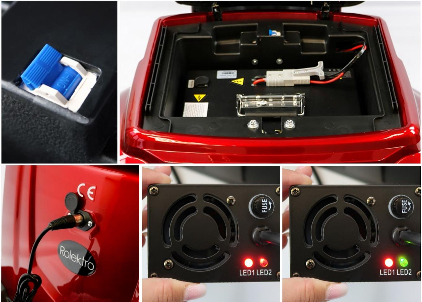
1. Bevor Sie das E-Trike über die Ladebuchse am Fahrzeug laden, muss der Hauptschalter unter der Sitzbank auf ON gestellt werden. Bitte prüfen!
