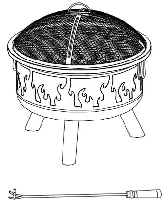
**SCHRITT 1** - Befestigen Sie 3 x Beine (F) an der Außenseite der Feuerstelle (E), mit den Schrauben (AA).
