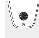
Drücken Sie den Ventilstift mit dem Finger nach unten und drehen Sie ihn nach LINKS (gegen den Uhrzeigersinn)
