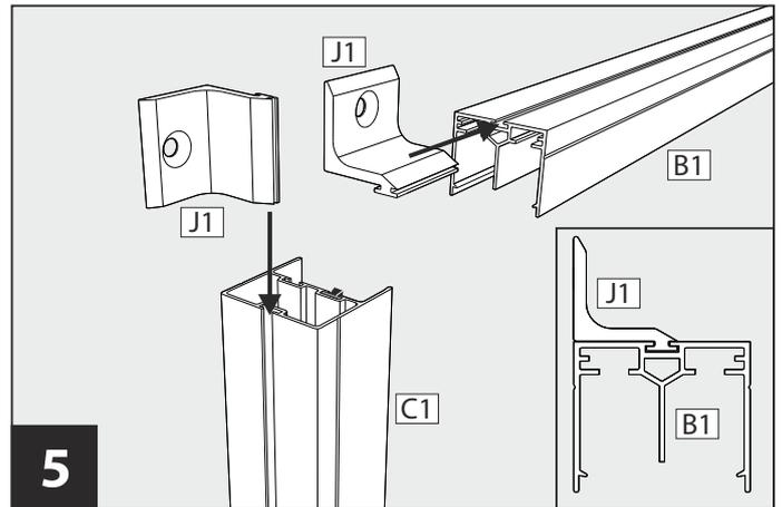
Winkel für die Frontmontage **J1** in das Führungsprofil **B1** und die Abschlussprofile **C1** einsetzen.
