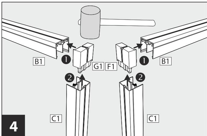
4 Führungprofil **B1** und Abschlussprofile **C1** mit Eckverbinder links **F1** und Eckverbinder rechts **G1** verbinden
