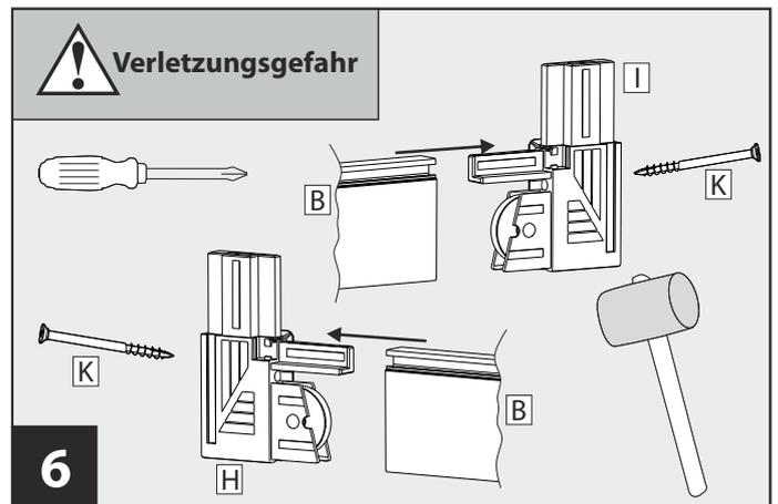
**6** Eckverbinder mit Rollen und links **H** und rechts **I** mit Trittschutzprofil **B** verbinden. Verwenden Sie gegebenenfalls einen Gummihammer. Beide Eckverbinder jeweils mit einer Senkkopfschraube **K** befestigen.
