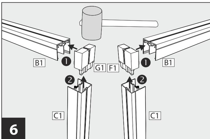
Führungsprofil **B1** und Abschlussprofile **C1** mit Eckverbinder links **F1** und Eckverbinder rechts **G1** verbinden
