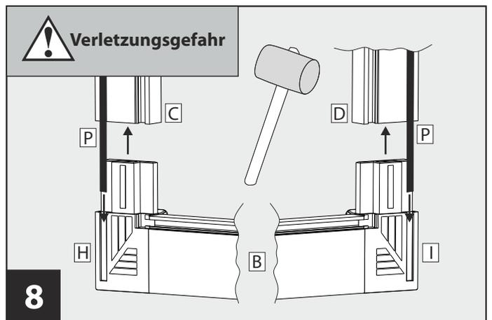
**8** Profile für die Höhe **C** und **D** auf die Eckverbinder mit Rollen links **H** und rechts **I** aufstecken. Verwenden Sie gegebenenfalls einen Gummihammer. Bürstendichtung **P** dabei in die Eckverbinder mit einschieben.
