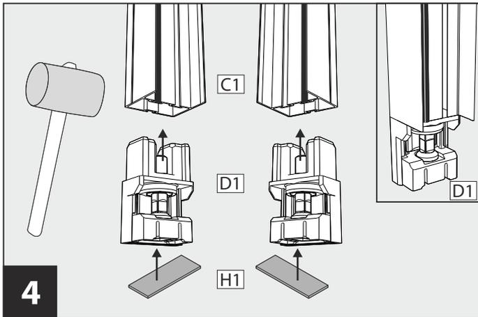
KlemmfüÙe **D1** unten auf die Abschlussprofile **C1** aufstecken.
