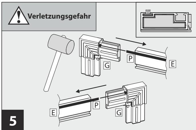
**5** Eckverbinder oben links/rechts **G** auf das Querprofil **E** aufstecken. Bürstendichtung **P** dabei in die Eckverbinder mit einschieben. Verwenden Sie gegebenenfalls einen Gummihammer.
