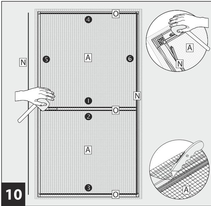
Gewebe **A** jeweils auf eine Schiebetür legen und ausrichten. Klemmleisten lang **N** und kurz **O** eindrücken und Überlänge kürzen (z. B. mit einem Seitenschneider, nicht im Lieferumfang enthalten).
