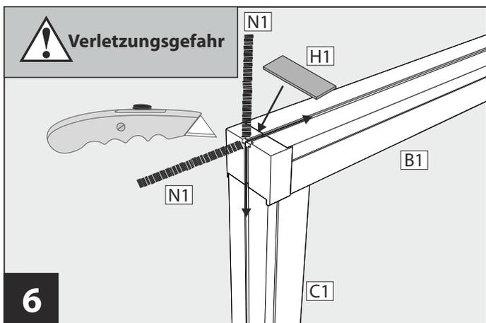
6 Bürstendichtung **N1** umlaufend in das Führungprofil **B1** und die Abschlußprofile **C1** einziehen und auf gleiche Länge kürzen.
