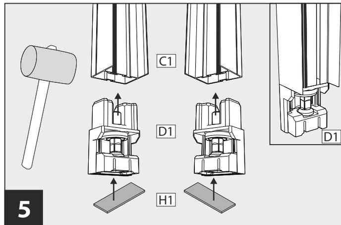
5 KlemmfüÙe **D1** unten auf die Abschlussprofile **C1** aufstecken.
