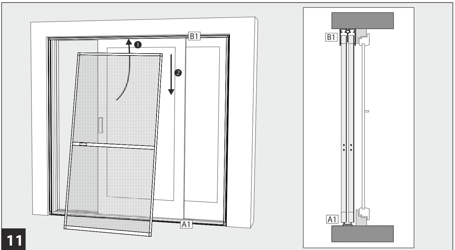
Fertig montierte Schiebetüren schräg von unten nach oben in das Führungsprofil **B1** des Zargenrahmens schieben und dann gerade nach unten auf die Laufschiene **A1** des Zargenrahmens setzen.
