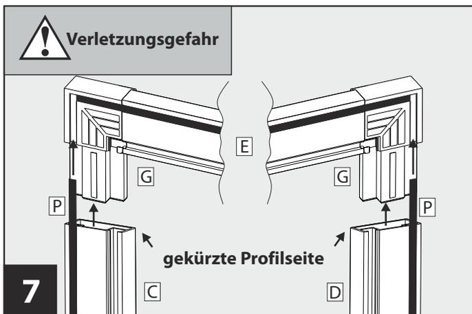
**7** Vormontiertes Querprofil **E** mit Eckverbinder oben links/rechts **G** auf den gekürzten Seiten der Profile für die Höhe **C** und **D** aufstecken. Verwenden Sie gegebenenfalls einen Gummihammer. Bürstendichtung **P** dabei in die Eckverbinder mit einschieben.
