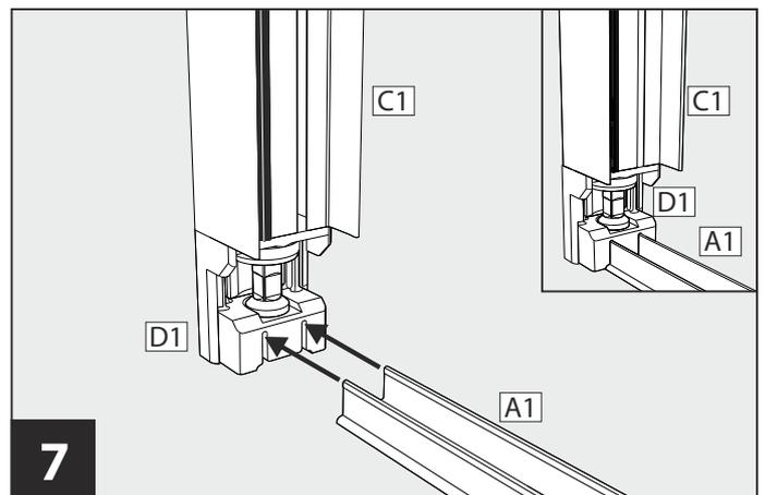
Laufschiene **A1** links und rechts in den KlemmfüÙen **D1** einsetzen.
