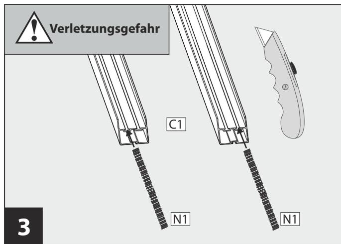
Bürstendichtung [N1] in die Abschlußprofile [C1] einsetzen und auf Profillänge kürzen.
