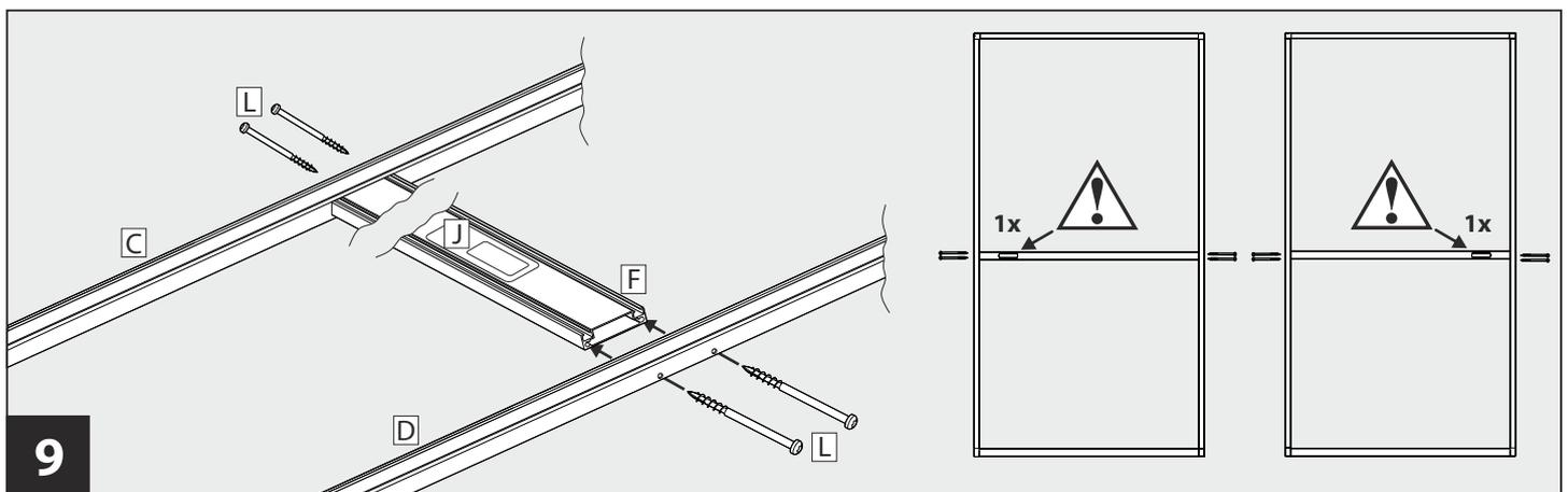
**9** Mittelprofil **F** zwischen die Profile für die Höhe **C** und **D** auf Höhe der Schraublöcher einsetzen und mit Linsenkopfschrauben **L** befestigen. **ACHTUNG!** Der bereits vormontierte Handgriff **J** im Mittelprofil **F** muss bei einer Tür nach links und bei der anderen Tür nach rechts zeigen.
