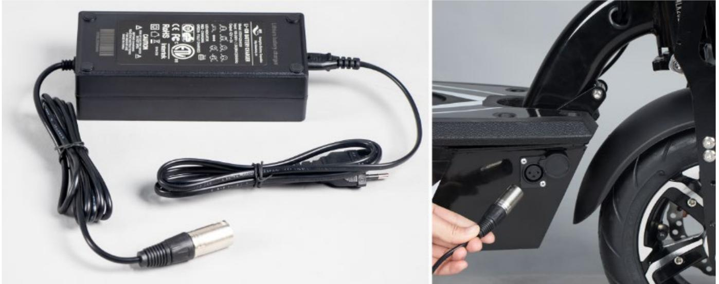
Schalten Sie die Zündung aus und schieben Sie die Schutzkappe der Ladebuchse beiseite. Stecken Sie den Stecker des Ladegeräts in die Ladebuchse und verbinden Sie das Ladegerät mit der Netz-Steckdose.
