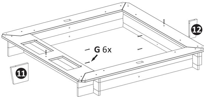
Die Stabilisationsbretter **11** und **12** am Sandkastenunterbau montieren.
