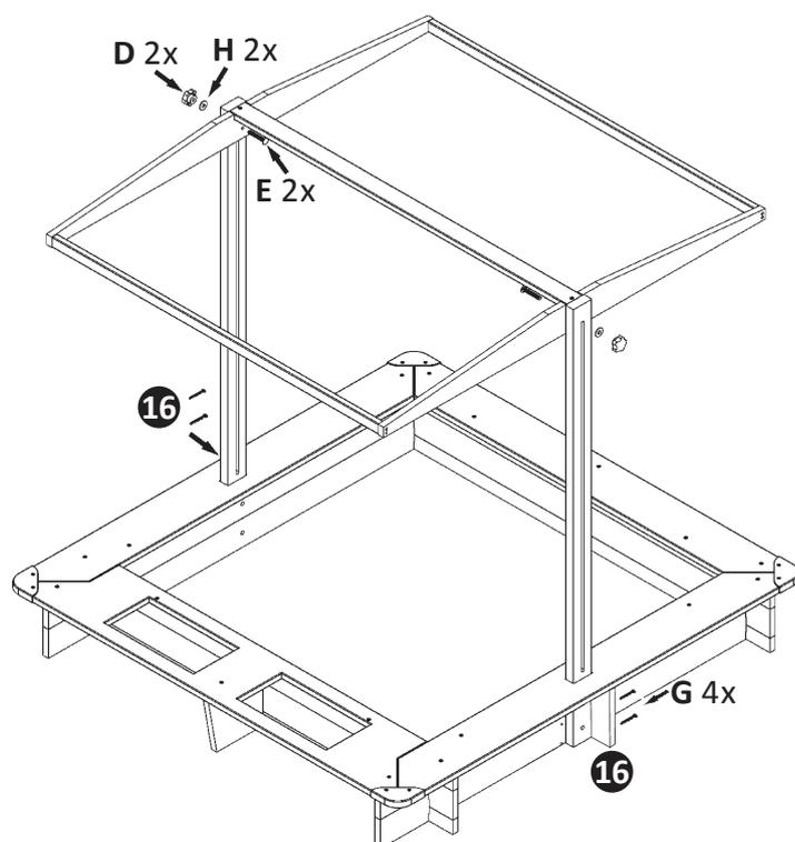
Das zusammengebaute Dach an der Dachhalterung montieren.
