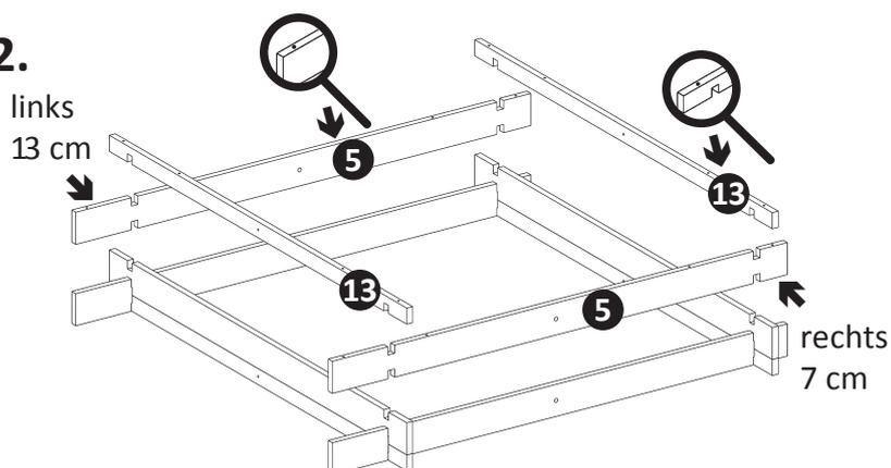
Die weiteren Teile des Sandkastenunterbaus aufstecken.
