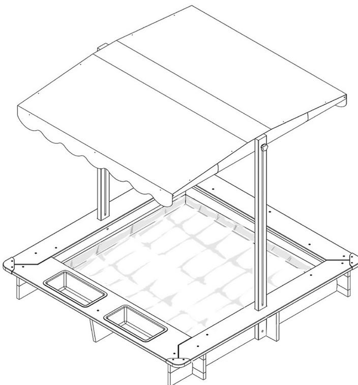
Je nach Sonneneinstrahlung kann das Dach schräg gestellt werden. Dazu die Sterngriffmuttern an beiden Seiten etwas lösen und bei neuer Neigung die Sterngriffmutter fest anziehen. Die Änderung der Neigung muss durch zwei Erwachsene erfolgen.
