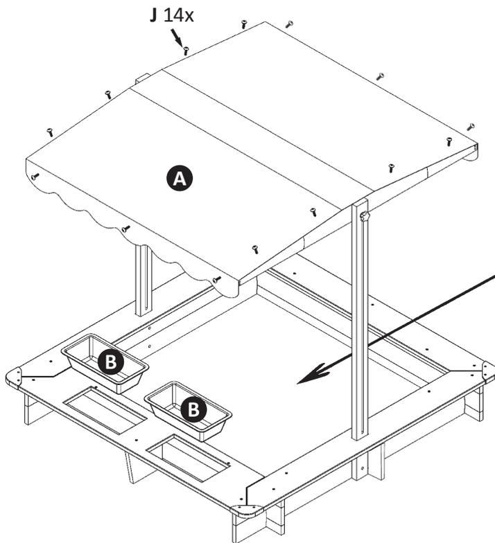
Die Dachplane mit den Klettbändern am Dach befestigen. Bei Bedarf die Dachplane zusätzlich mit den Schrauben J am Dach montieren.
