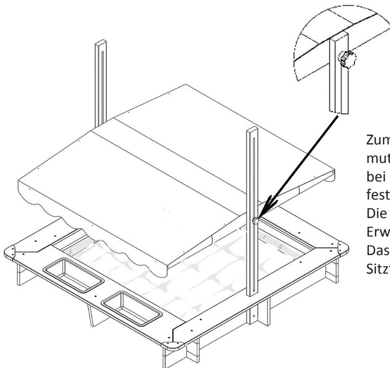
Zum Bewegen des Daches die Sterngriffmuttern an beiden Seiten etwas lösen und bei neuer Position die Sterngriffmuttern fest anziehen.
