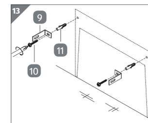
1. Stecken Sie die Dübel 11 in die Bohrlöcher.
