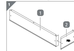
1. Bringen Sie die Bohrung eines kurzen Seitenteils 2 mit der Bohrung eines langen Seitenteils 1 wie abgebildet übereinander.
