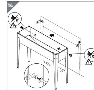
1. Schrauben Sie die abgebildeten zwei Schrauben 7 samt Muttern 8 für die Befestigung des Hochbeets ab.
