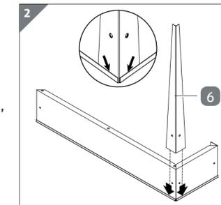
1. Fixieren Sie die Seitenteile, indem Sie ein Standbein 6 auf die Kante stecken. Achten Sie darauf, dass Sie dabei das Standbein in die Kerbe an den Seitenteilen führen.
