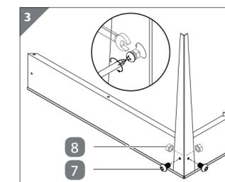
1. Schrauben Sie das Standbein 6 mit zwei Schrauben 7 und zwei Muttern 8 fest. Drehen Sie dabei mithilfe des Schraubenschlüssels die Muttern und die Schrauben mit dem Kreuzschlitz-Schraubendreher gegeneinander fest.
