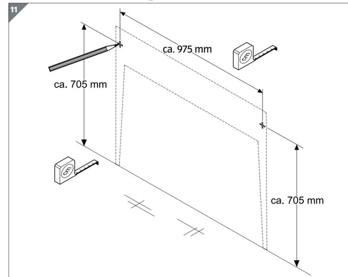
– Übertragen Sie die Maße mithilfe eines Maßbands und markieren Sie die Bohrlöcher an der Wand.
