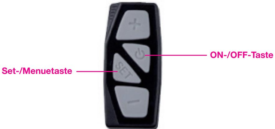
Mit den Tasten **+** und **-** wird die Tretunterstützung eingestellt. Jeder Tastendruck führt in die nächsthöhere (**+**) bzw. niedrigere (**-**) Tretunterstützung.
