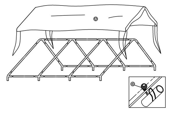
3. Fixieren Sie unter jedem Stehpfosten 3 einen Fußteller 7 mittels der Schraube 8. Heben Sie den Pavillon an und setzen Sie die Stehpfosten 3 vertikal in die Verbinderelemente 4 und 5. Nun können Sie bereits weitere Spanngumnis entlang der langen 6m Seiten setzen.
