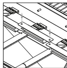
1. Schrauben lösen und Befestigung abheben.
