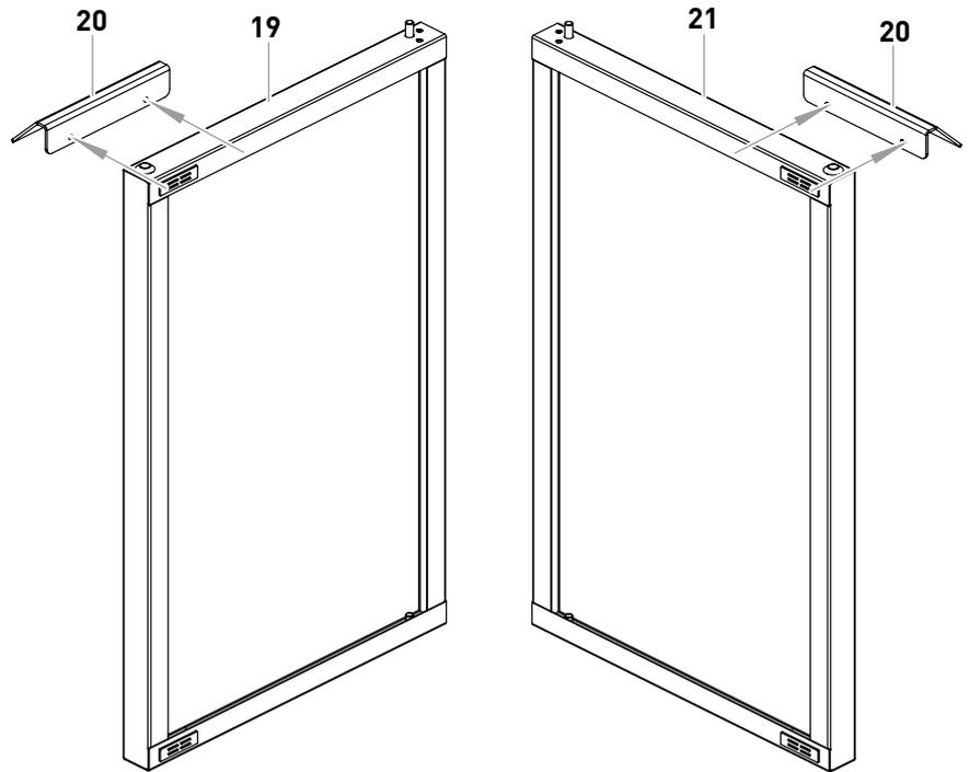
Entfernen Sie die vormontierten Schrauben (4 Stück) und befestigen Sie mit diesen die Halterungen der Türen.
