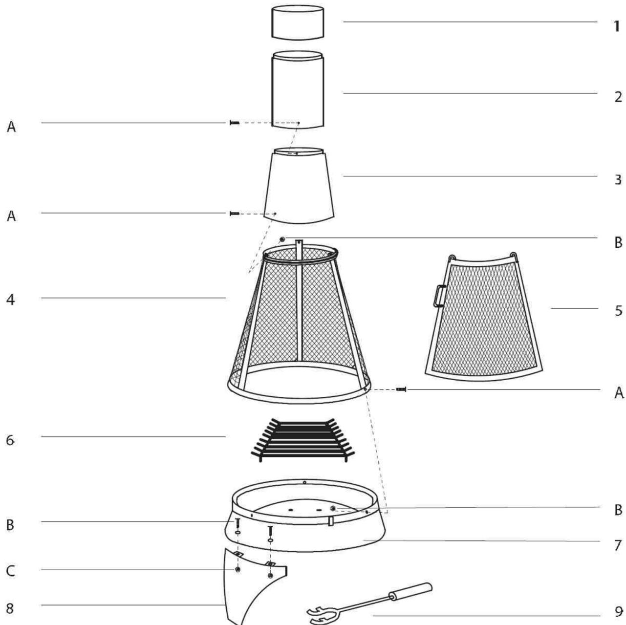
**SCHRITT 1** - Verbinden Sie den Rauchabzug (3) mit dem unteren Abzug (2). Benutzen Sie hierzu 3 x Schrauben (A) und 3 x Muttern (B)
