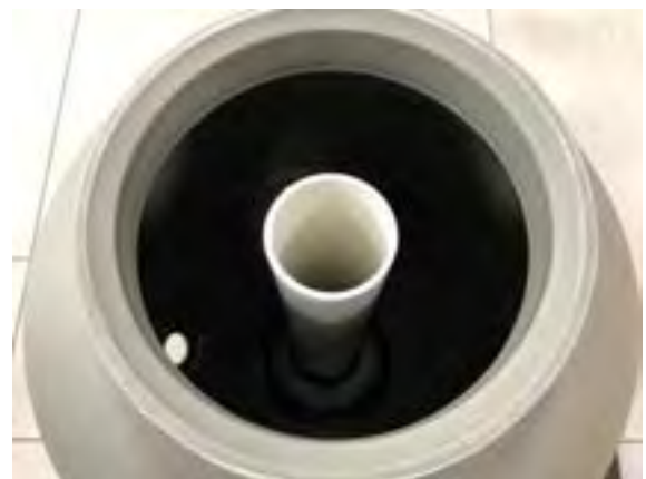
Abb. Innenverrohrung stehend (mittig) im Filterkessel
