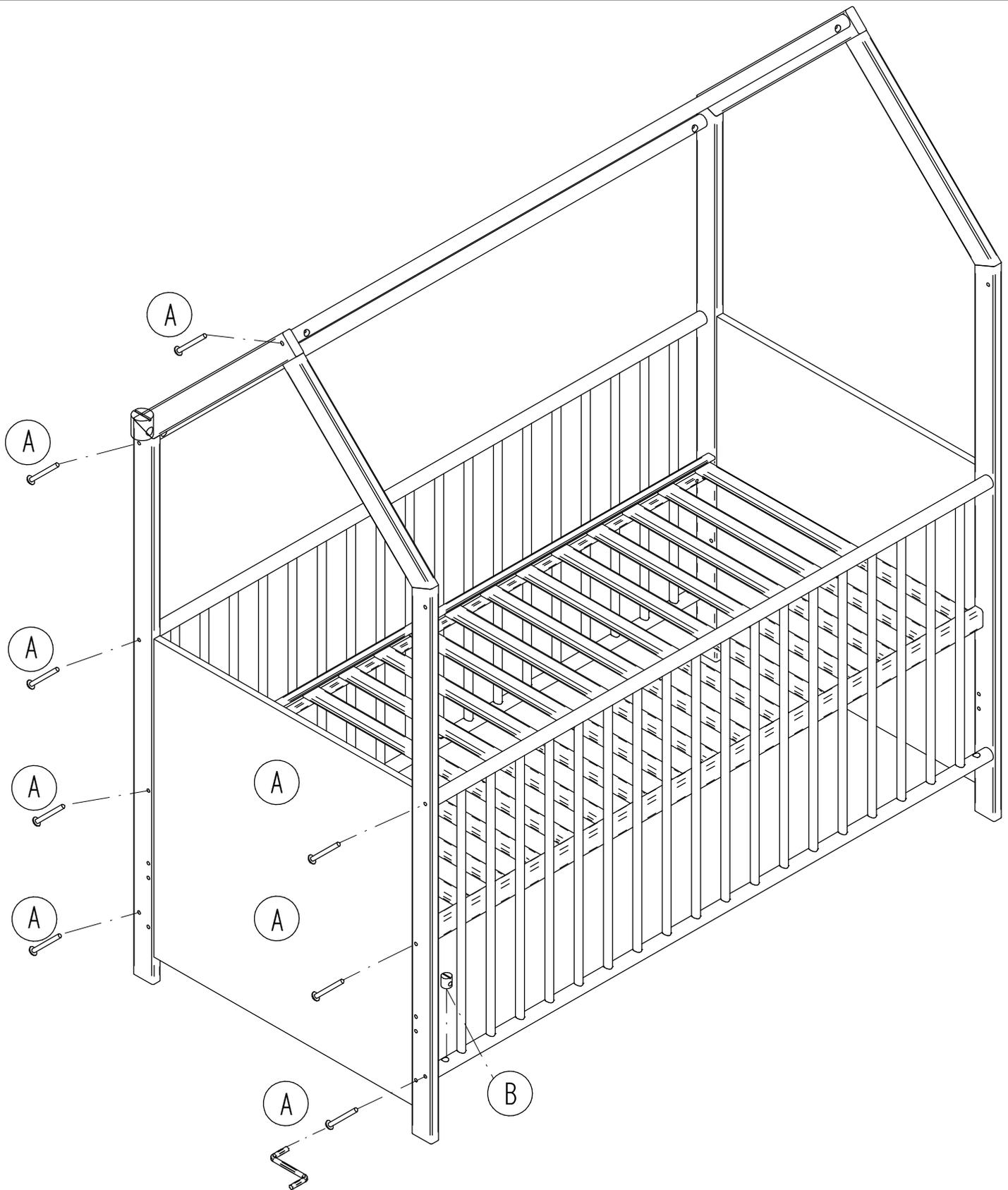
Die vormontierten Kopfteile mit den Gittern und dem Rost verbinden. Kloben Pos B und Schrauben Pos A
