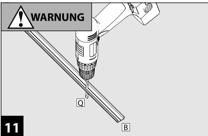
Bohren Sie das Wandprofil **B** an drei auf die Länge gleichmäßig verteilten Position vor.
