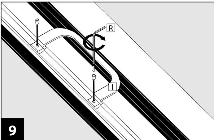
Schieben Sie den Handgriff **I** auf eine für Sie angenehm zu bedienende Höhe. Wir empfehlen ca. 105 cm ab Boden.
