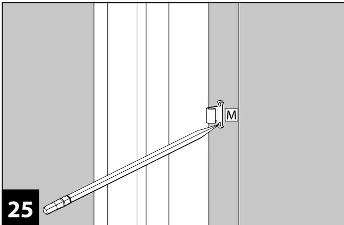
**25** Zeichnen Sie die Bohrlöcher für den Schließhaken **M** an. Dabei sollte der Schließhaken **M** auf gleicher Höhe wie der Handgriff **I** liegen.
