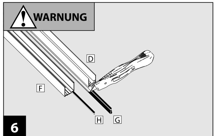
Ziehen Sie die Bürstendichtung Griffprofil **G** in das Griffprofil **D** ein.
