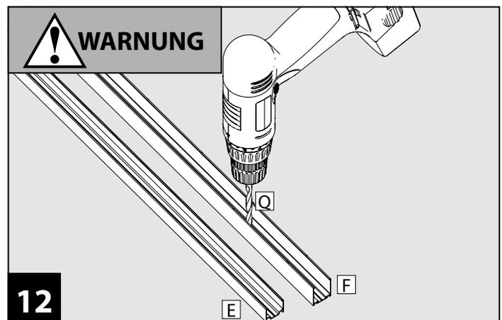
Bohren Sie die Führungsprofile oben **F** und unten **E** jeweils an drei auf die Länge gleichmäßig verteilten Position vor.
