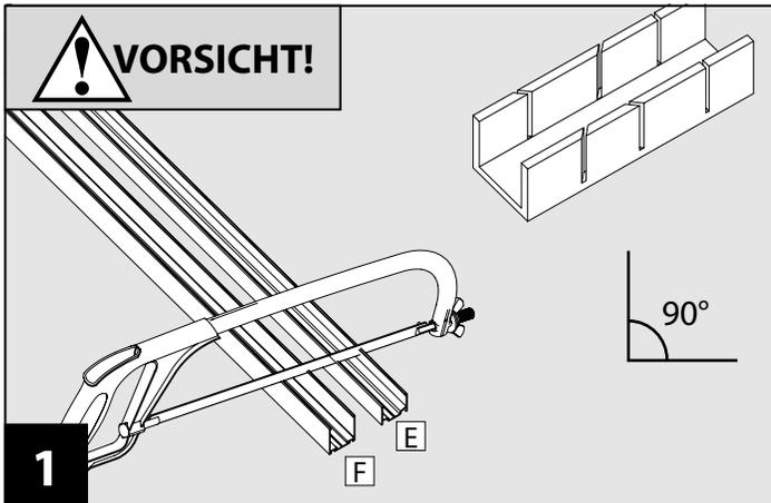
Kürzen Sie das Führungsprofil oben **F** und das Führungsprofil unten **E** auf gemessene Breite - 1,8 cm.
