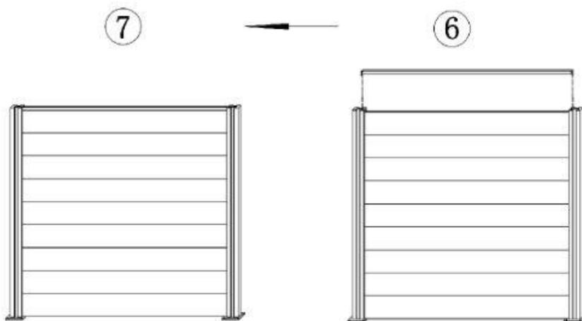
**Option Schrägelement:** Schieben Sie nun die WPC-Elemente **(D)** von oben zwischen die Pfosten. Beginnen Sie hierbei mit den längsten Elementen.
