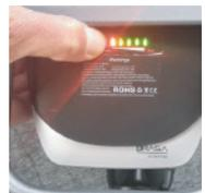
Die optimale Leistung erzielt eine neue Batterie erst nach ca. 2 bis 3 Lade- und Entladezyklen. Bei Nichtbenutzung des Fahrrades sollte dieses temperiert (zwischen 7°C und 10°C) gelagert werden. Eine Lagerung sollte ferner nicht bei vollgeladener oder vollständig leerer Batterie erfolgen.
