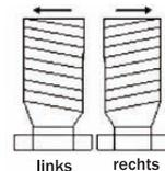
Das Pedal mit der Aufschrift **R** in Fahrtrichtung rechts in das Gewindeauge der Tretkurbel (12) einschrauben. Das Pedal mit der Aufschrift **L** links anbauen.
