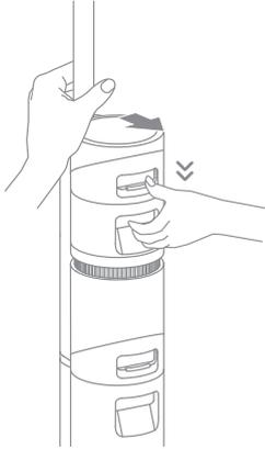
2. Öffnen Sie den Tankdeckel und füllen Sie ausreichend sauberes Wasser in den Reinwassertank.
