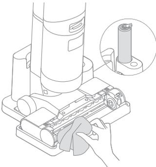
4. Richten Sie nach der Reinigung das rechte Ende der Walzenbürste auf den rechten Schlitz am Gerät aus und schieben Sie das linke Ende in den linken Schlitz am Gerät, bis sie einrastet.
