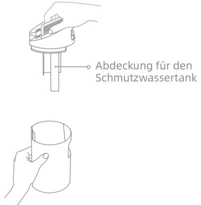
3. Spülen. Sie den Tank und die Tankabdeckung mit sauberem Wasser. Die mitgelieferte Reinigungsbürste kann verwendet werden, um die Innenwand des Tanks zu reinigen.
