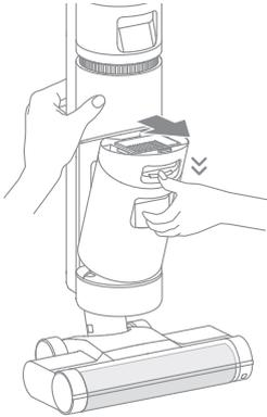
2. Halten Sie den Tank mit einer Hand und ziehen Sie die Tankabdeckung mit einer anderen Hand nach oben. Gießen Sie das Schmutzwasser aus.
