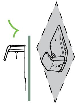
Wenn Ihr Rasen eine weiche oder unebene Fläche hat, empfehlen wir, den Bereich rund um die Ladestation mit einem Rasenschutzzitter zu verstärken. Andernfalls kann die wiederkehrende Belastung durch die Hinterräder den Rasen beschädigen. Wenn Sie die Ladestation aufgestellt und das elektrische Anschlusskabel verlegt haben, schließen Sie die Begrenzung des Mähbereichs ab, bevor Sie die Ladestation mit der Steckdose verbinden.
