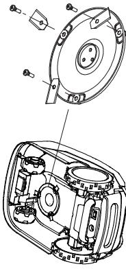
Ein Satz Ersatzmesser wird mit dem Mähroboter geliefert. Weitere Messer können über den Kundendienst gekauft werden. Damit Sie die beste Leistung von Ihrem Gerät erhalten, ersetzen Sie immer alle drei Messer gleichzeitig. Benutzen Sie nur vom Hersteller empfohlene Ersatzteile.
