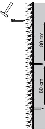
Treiben Sie die Heringe zunächst nur ein wenig mit einem leichten Hammer in den Boden, bis Sie sich sicher sind, dass sie korrekt positioniert sind. Um sicherzustellen, dass Sie die Heringe korrekt positionieren, empfiehlt es sich, dass Sie die Heringe zuerst auf dem Rasen auslegen und den Abstand von den Rasantern und den Hindernissen messen (30 cm).
