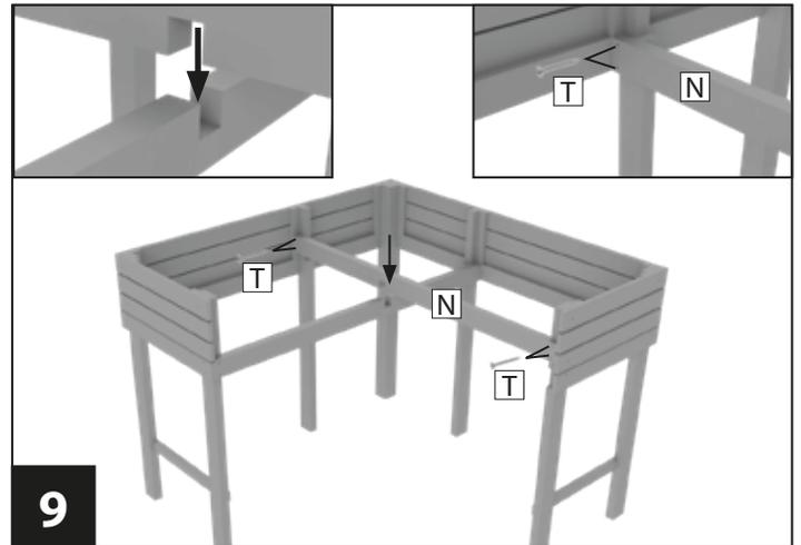
Setzen Sie die zweite Mittelstrebe **N** mit der nach unten zeigenden Aussparung auf die erste Mittelstrebe **M** auf. Siehe dazu Detailbild.
