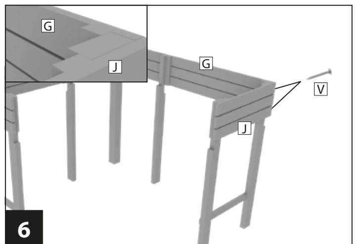
**6** Befestigen Sie das zweite vormontierte kurze Seitenteil **J** am Ende des langen Seitenteils **G**. Verwenden Sie dazu die Schrauben **V**.
