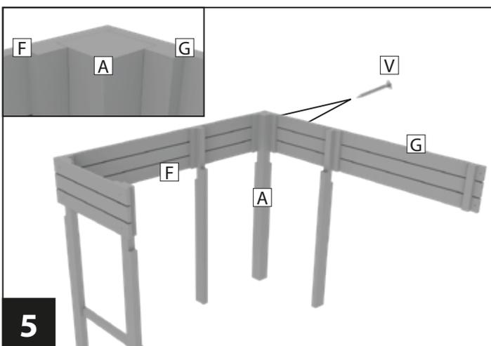
**5** Befestigen Sie das zweite vormontierte lange Seitenteil **G** am Eckpfosten **A**. Verwenden Sie dazu die Schrauben **V**.
