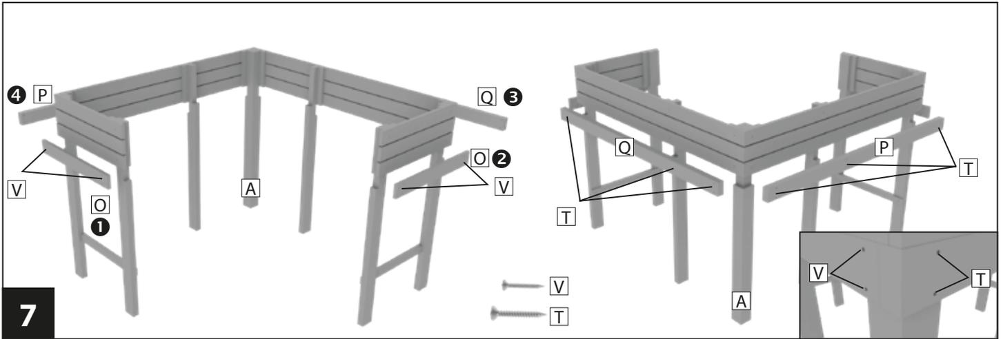
Befestigen Sie direkt unter den Seitenteilen jeweils die Abschlüsse kurz **O**, lang 1 **P** und lang 2 **Q**.
