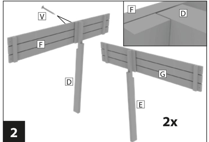
**2** **2 Stück lange Seitenteile montieren:**
