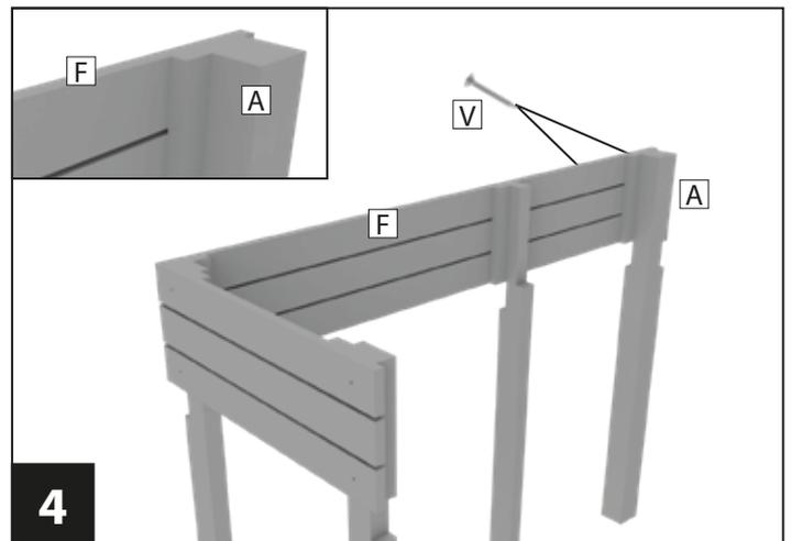
**4** Befestigen Sie am Ende des langen Seitenteils **F** den Eckpfosten **A**. Verwenden Sie dazu die Schrauben **V**. **ACHTUNG!** Die Aussparungen am Eckpfosten **A** zeigen dabei jeweils nach Außen.
