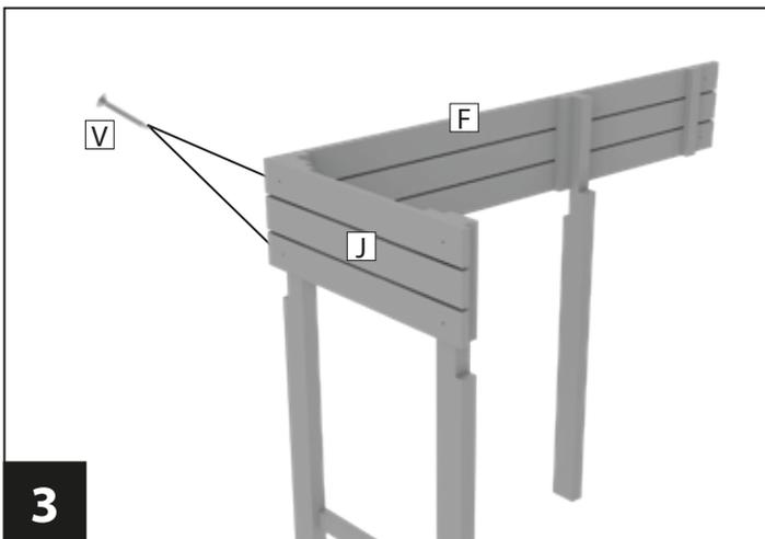
**3** Verbinden Sie ein vormontiertes kurzes Seitenteil **J** mit dem vormontierten langen Seitenteil **F**. Verwenden Sie dazu die Schrauben **V**.
