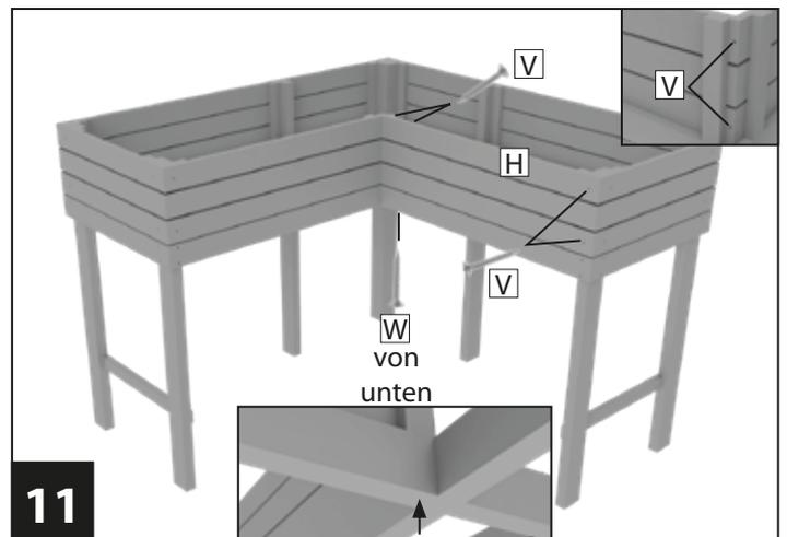
Befestigen Sie das Seitenteil mittel 2 **H** mit den Schrauben **V** und **W**. Dabei wird die Schraube **W** von unten eingedreht.
