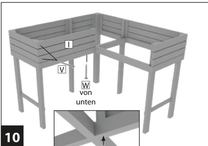
Befestigen Sie das Seitenteil mittel 1 **I** mit den Schrauben **V** und **W**. Dabei wird die Schraube **W** von unten eingedreht.
