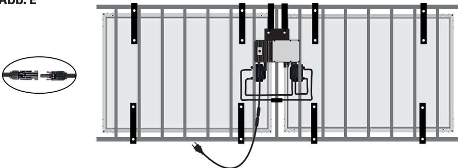
1. Schließen Sie die Kabel der Anschlussboxen der Solarpanele an den Wechselrichter an bis sie eingerastet sind (siehe **Abb. E**). Die Paneele werden in Serie an einen Eingang des Wechselrichters angeschlossen.
